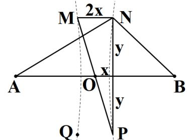
**Câu 33:** Đặt điện áp  $u = 150\sqrt{2} \cos(100\pi t)$  V vào hai đầu đoạn mạch mắc nối tiếp gồm điện trở thuần  $R = 60\Omega$ , cuộn dây L (có điện trở trong r) và tụ điện C. Công suất tiêu thụ điện của đoạn mạch bằng 250 W. Nối hai bản tụ điện bằng một dây dẫn có điện trở không đáng kể. Khi đó điện áp hiệu dụng giữa hai đầu điện trở bằng điện áp hiệu dụng giữa hai đầu cuộn dây và bằng  $50\sqrt{3}$  V. Dung kháng của tụ điện có giá trị bằng
