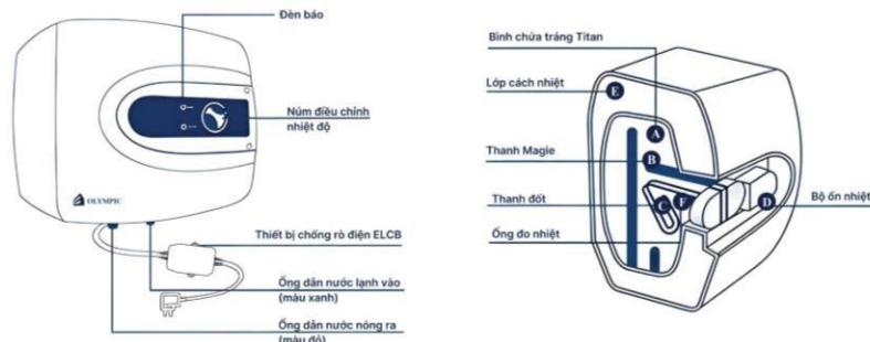
Đối với bình nước nóng gián tiếp, nước lạnh được dẫn vào qua van một chiều có thể tích 25 lít khi chứa đầy bình. Mỗi lần hoạt động, nước lạnh được đun nóng bằng thanh đốt để nhiệt độ tăng đến  $80^{\circ}\text{C}$  thì rơ le nhiệt sẽ tự ngắt điện. Biết khối lượng riêng của nước  $\rho = 1000 \text{ kg/m}^3$ ; nhiệt dung riêng của nước là  $c = 4180 \text{ J/(kg.K)}$ ; bình có công suất  $3000 \text{ W}$  và hiệu suất đun bằng thanh đốt của bình là  $H = 90\%$ .
