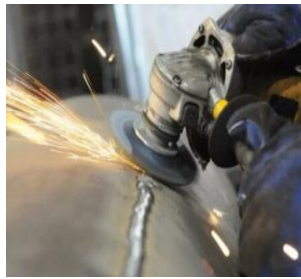
Hình 3: Mối hàn kim loại đang được mài nhẵn.
